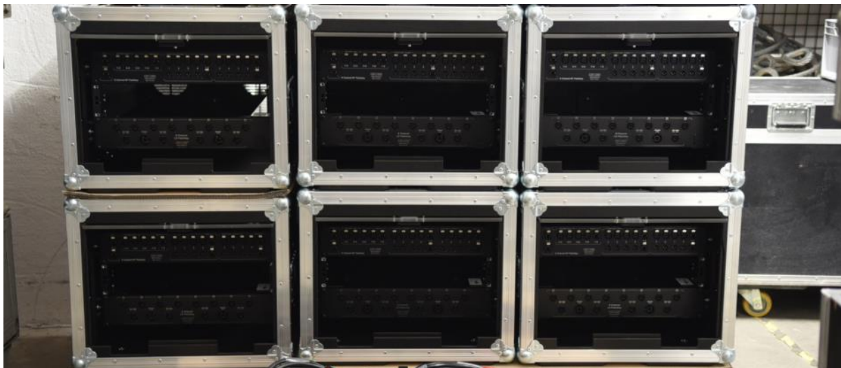
Vorbestückte Racks zur Auslieferung, Rollen für Transport demontiert
